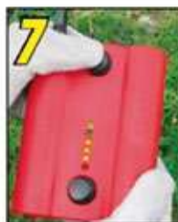
7 Presione el botón "Operar" hasta que se inicia la reacción exotérmica.
