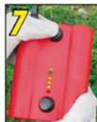
Presione el botón "Operar" hasta que se inicia la reacción exotérmica.
